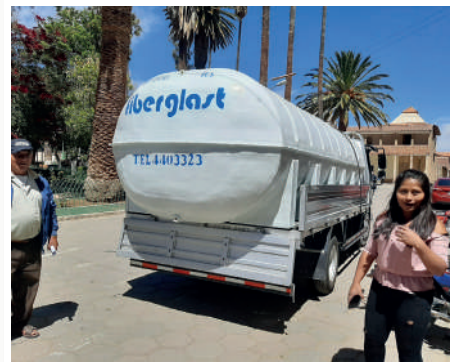
Adquisición dos tanques de plástico - fibra de vidrio capacidad 10.000.00 litros agua potable Villa Carino
